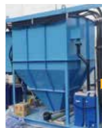
濁水処理装置 (塗膜が混ざった濁水を凝集・ろ過)
